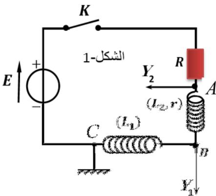
$$1- \text{ اثبت أن المعادلة التفاضلية التي يحققها شدة التيار } i(t) \text{ المار بالدائرة من الشكل: } \frac{di(t)}{dt} + \frac{R+r}{L_1+L_2} i(t) = \frac{E}{L_1+L_2}$$
